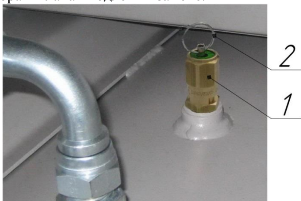
Рисунок 10 – Клапан предохранительный пружинного типа
