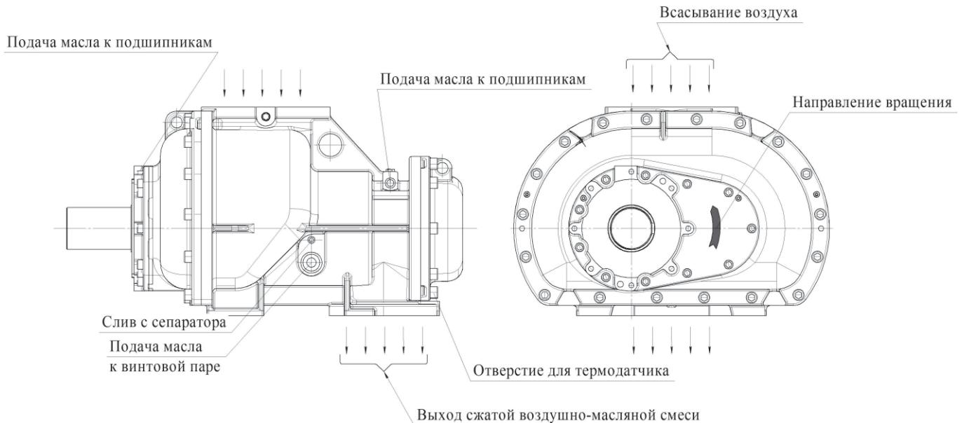
Рисунок 4 – Общий вид блока винтового VMX250RD
