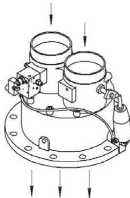
Рисунок 8 – Клапан всасывающий
