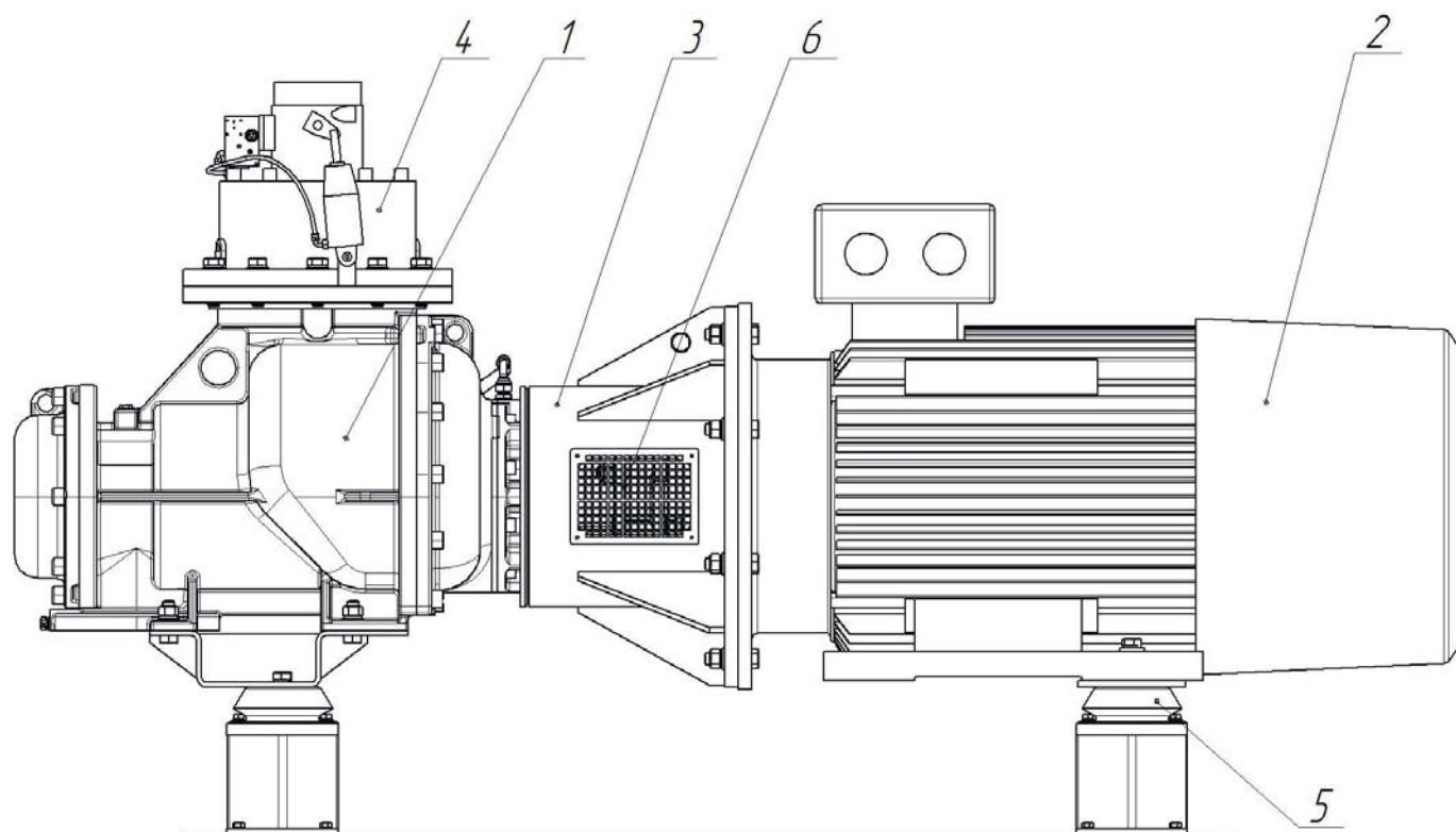
1 – винтовой блок, 2 – электродвигатель, 3 – кожух, 4 – клапан всасывающий,
