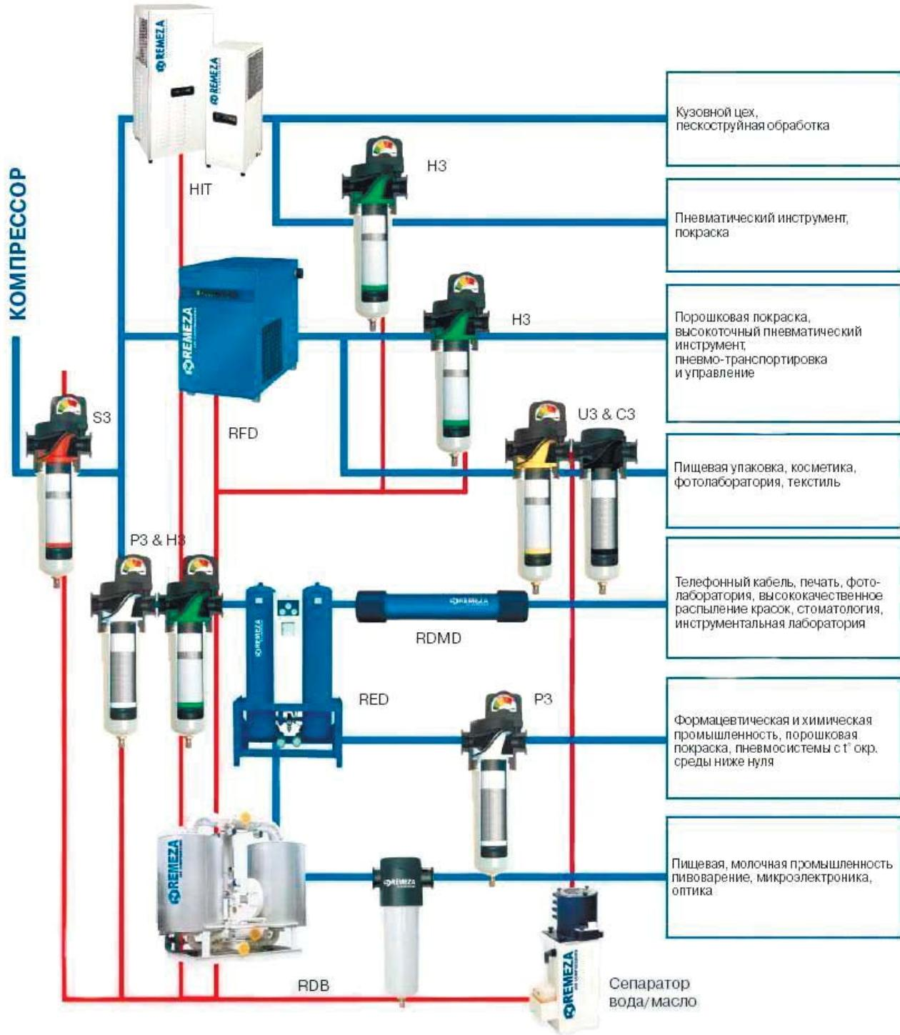
Рисунок 12 – Схема комплектной компрессорной системы
