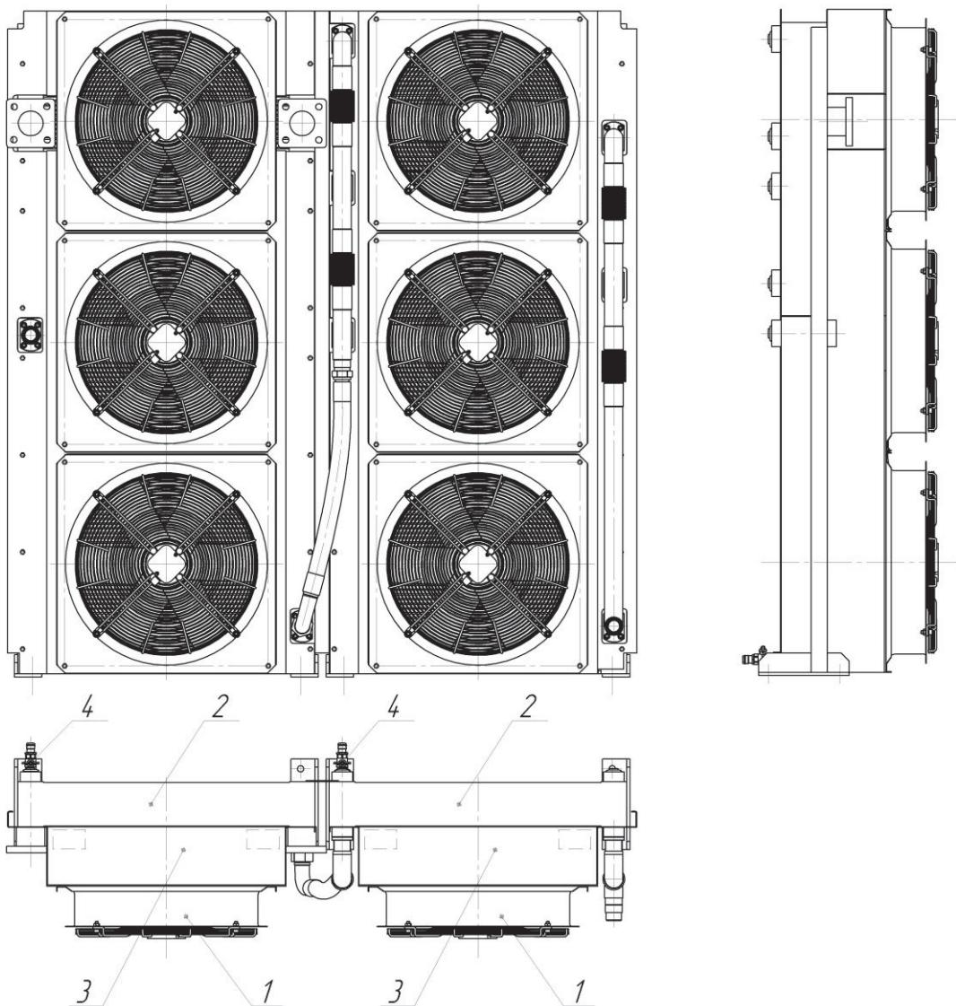
1 – электровентилятор, 2 – радиатор, 3 – диффузор, 4 – кран слива, 5 – каркас.
