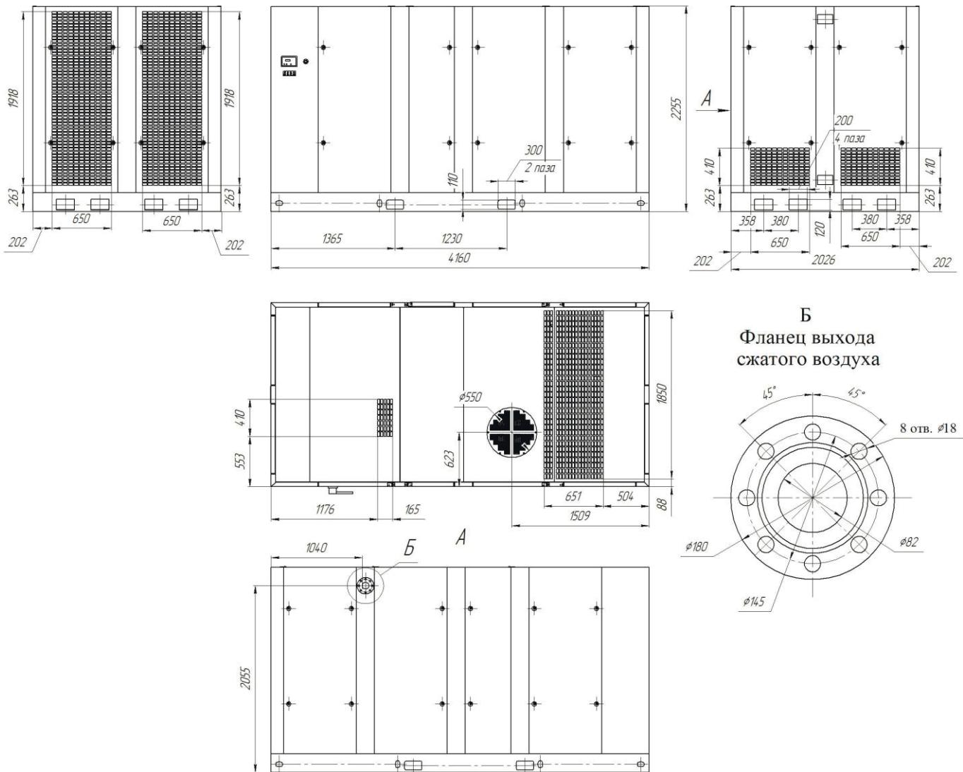
Рисунок А.1 Габаритные и присоединительные размеры компрессорных установок
