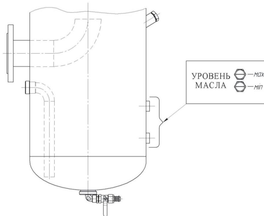
Примечание: Оптимальная температура окружающей среды для контроля граничных значений (max и min) уровня масла равна  $20 \pm 5^{\circ}\text{C}$ .
