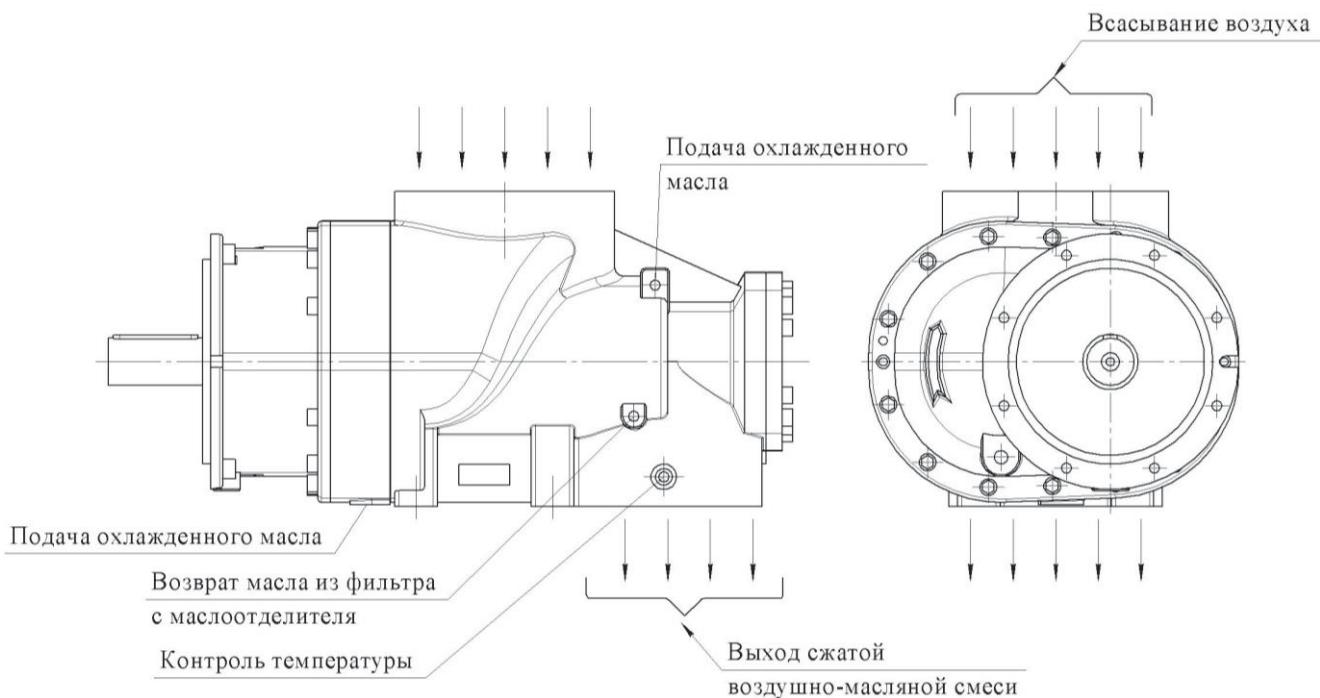
**ВНИМАНИЕ: НАПРАВЛЕНИЕ ВРАЩЕНИЯ ВАЛА ВИНТОВОЙ ГРУППЫ УКАЗЫВАЕТ СТРЕЛКА, РАСПОЛОЖЕННАЯ НА ВИНТОВОМ БЛОКЕ СО СТОРОНЫ ТОРЦА ВАЛА.**
