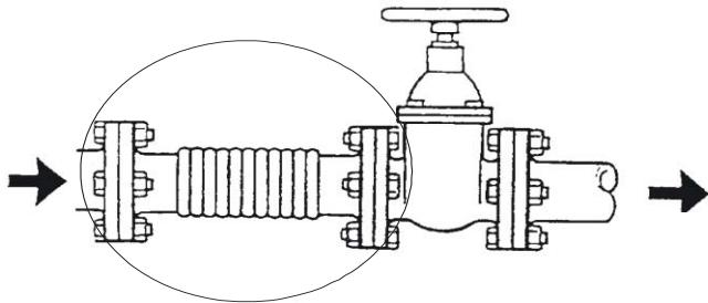
Перед пуском отсекающий кран обязательно должен быть открыт. Трубопроводы следует укладывать с уклоном 0,005 в сторону линейных влагоотделителей.
