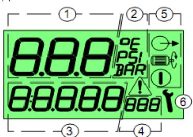
1, 2 - Давление воздуха на выходе компрессорной установки или код параметра в режиме программирования.
