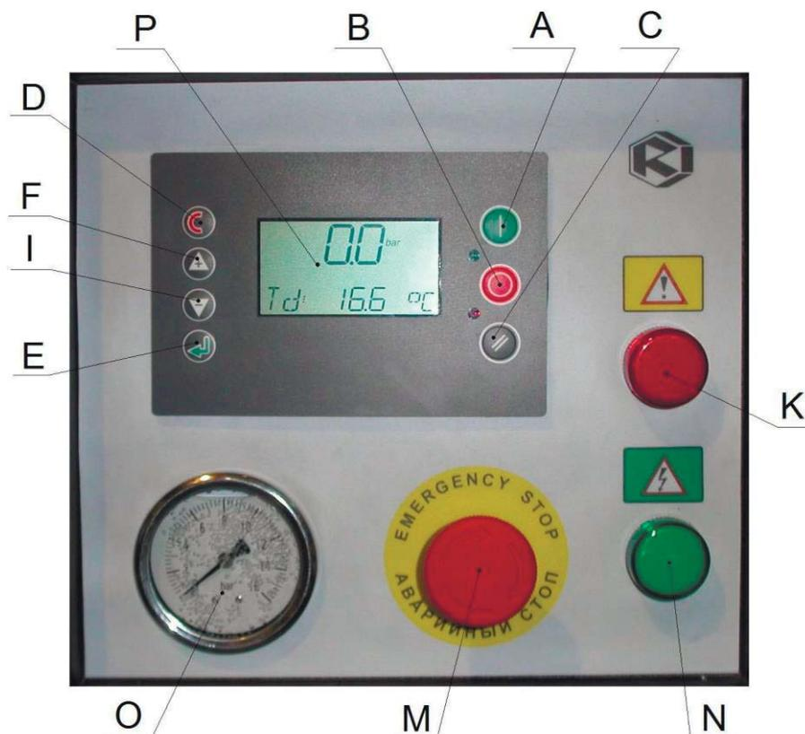
**А** - кнопка "ПУСК" – вход в состояние ЗАПУСКА.
