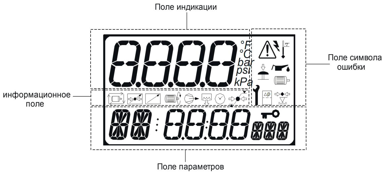
Рис. 1. Дисплей контроллера
