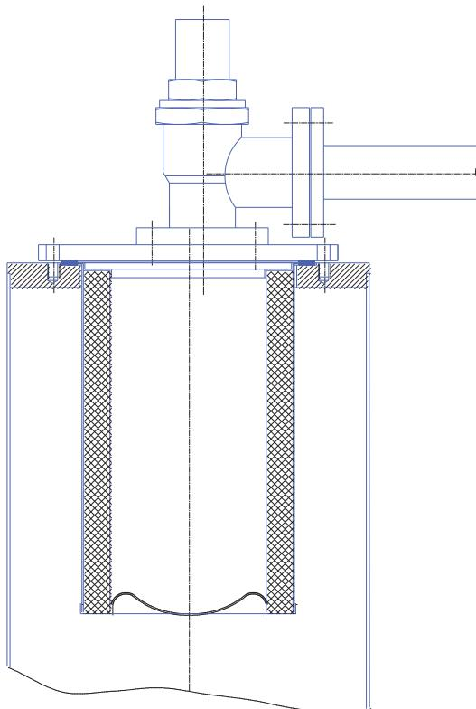
ВНИМАНИЕ: ПРИ СНЯТИИ КРЫШКИ НЕ ПОВРЕДИТЕ ТРУБКУ ОТВОДА МАСЛА ИЗ КАРТРИДЖА (УСТАНОВЛЕНА НА ВНУТРЕННЕЙ СТОРОНЕ КРЫШКИ).
