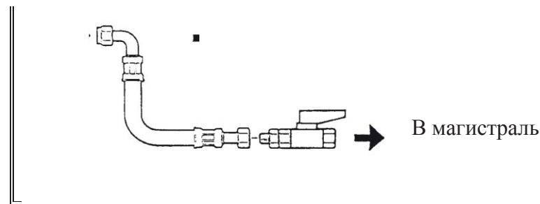
Перед пуском отсекающий кран обязательно должен быть открыт. Трубопроводы следует укладывать с уклоном 0,005 в сторону линейных влагоотделителей.
