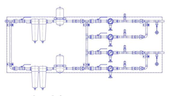
Рисунок 7 – Система подготовки сжатого воздуха
