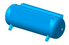
Рисунок 3 – Общий вид ресивера Р500.11.10
