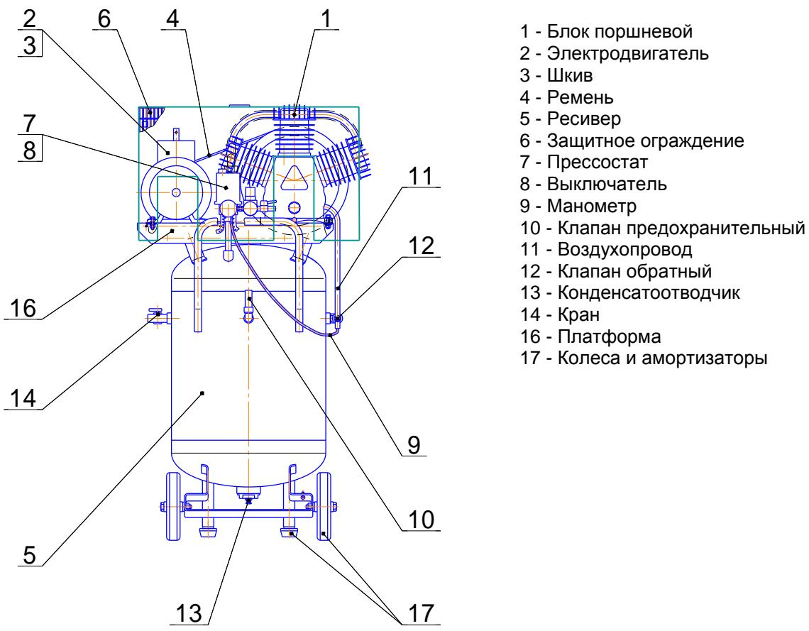
Рисунок 7 - Общий вид компрессора СБ4/C-100.LB40B
