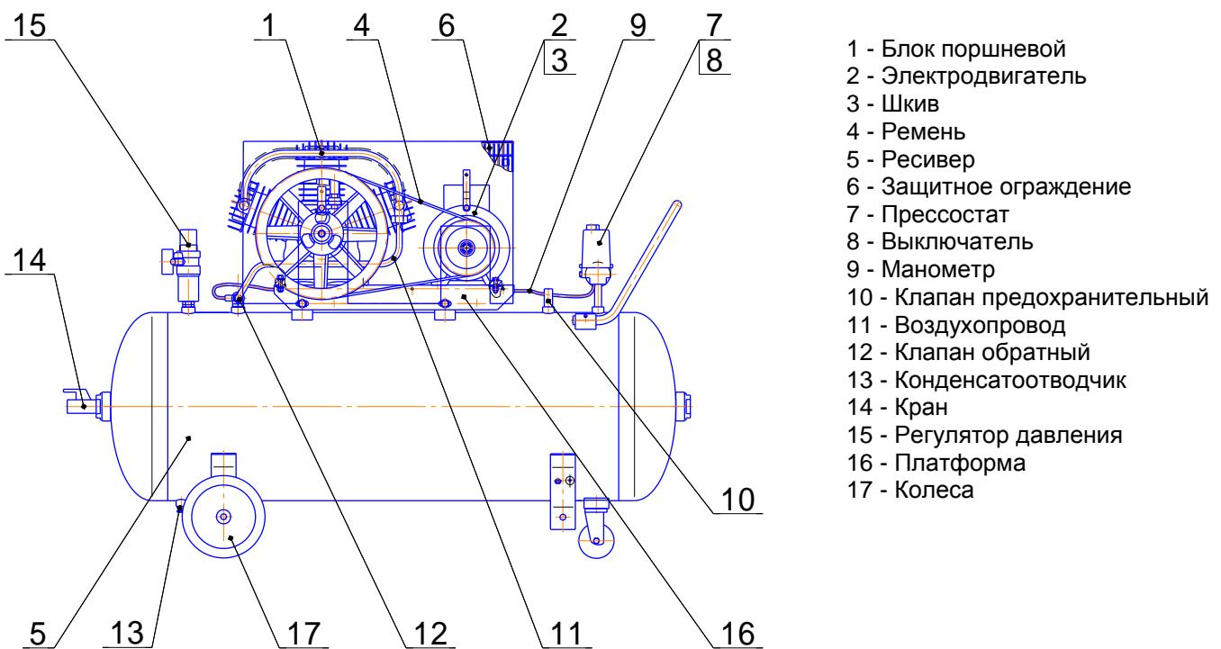
Рисунок 8 - Общий вид компрессора СБ4/C-200.LB40
