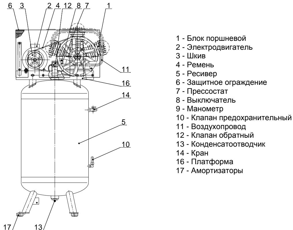
Рисунок 9 - Общий вид компрессора СБ4/Ф-270.ЛВ40В
