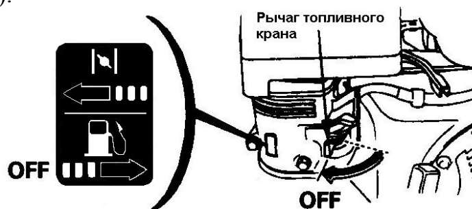
Рисунок 12 – Рычаг топливного крана в положении "OFF" ("Выключено")
