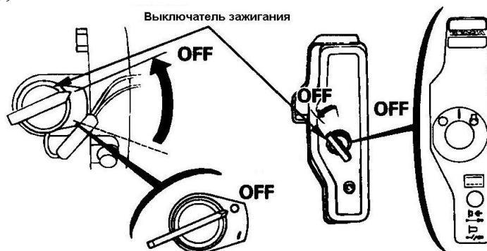
Рисунок 11 – Выключатель зажигания в положении "OFF" ("Выключено")
